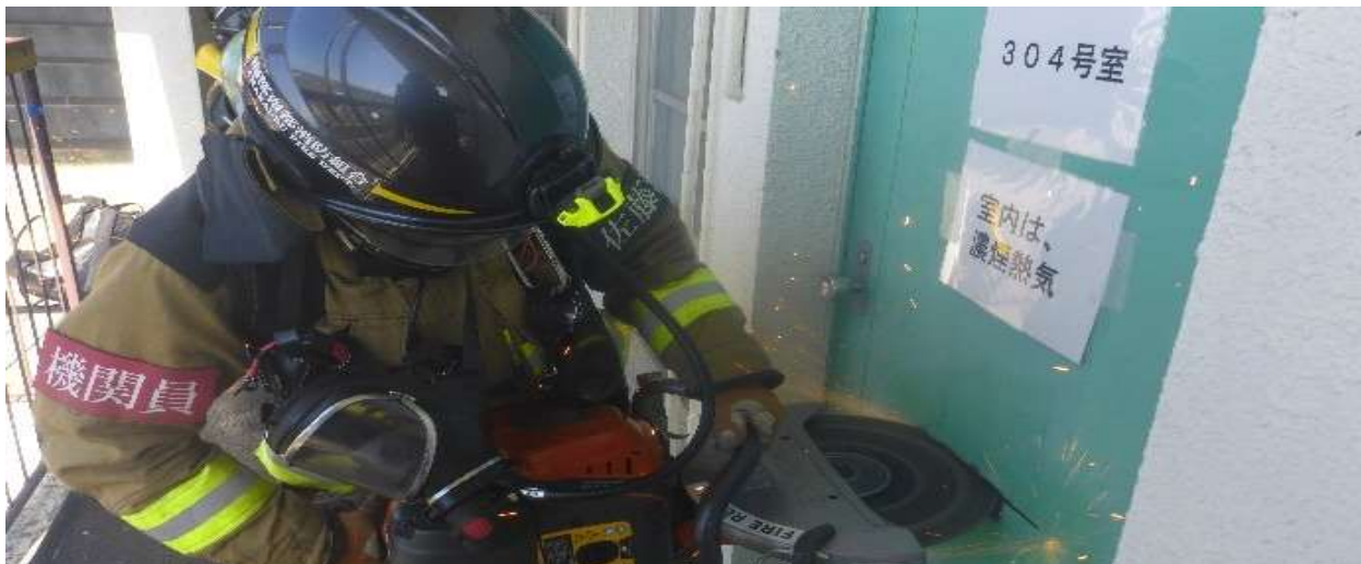
01 エンジンカッターによる扉の破壊。要救助者のもとへ進入路を確保する。
