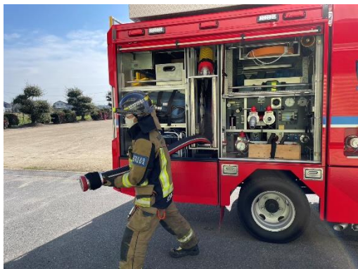
水を吸うための吸管は左右どちらからでも伸ばすことができます。
