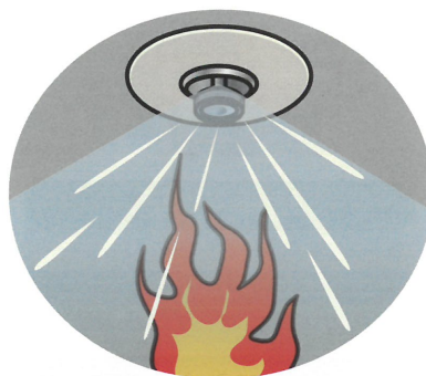
スプリンクラー設備
